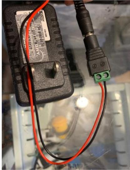
**Imagen 4. Cables de voltaje del monedero (rojo y negro) conectados a un adaptador de 12V.**
