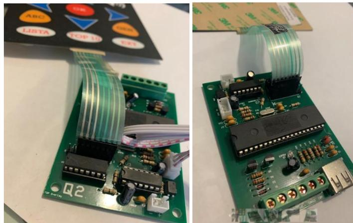
Imagen 4. Membrana conectada a pulsador vista frontal y posterior.
