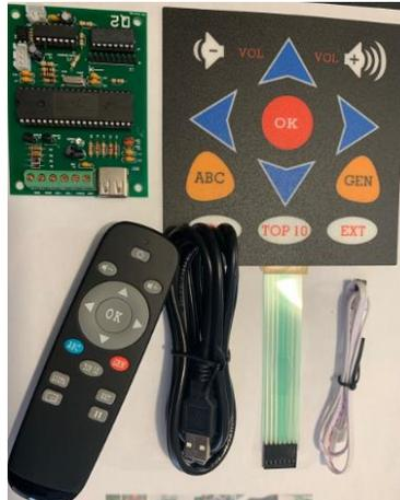
Imagen 1. Membrana con cable USB, pulsador, control y cable con receptor.
